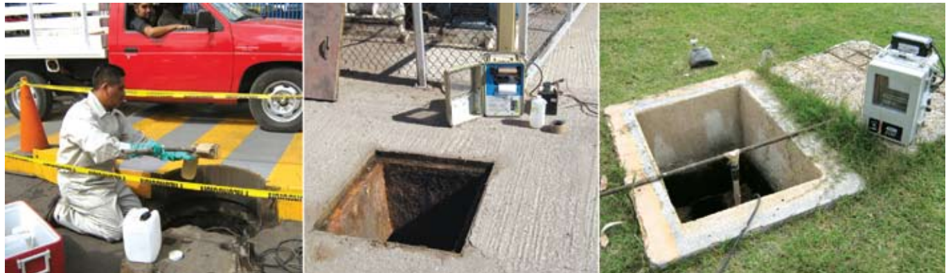
De izquierda a derecha: visita de inspección a la empresa Tisamatic, S.A.; toma de muestra en el drenaje de la empresa Chicles Canel's y medición de caudal para la empresa Continental Tire.
