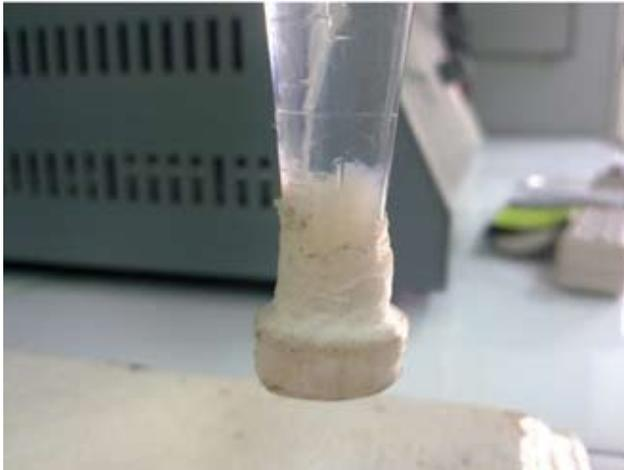
Al analizar la muestra, se observó una mínima precipitación del hidróxido de aluminio, además de haberse restituido la concentración de flúor original medida en la entrada de la celda.
