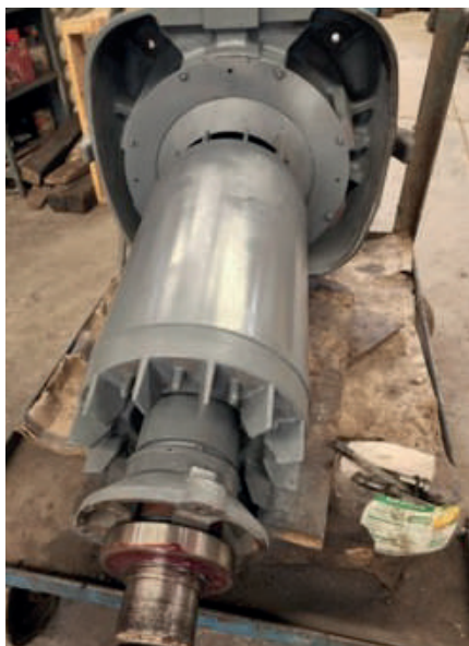
Mantenimiento de motor de 200 hp de pozo El Paseo II
