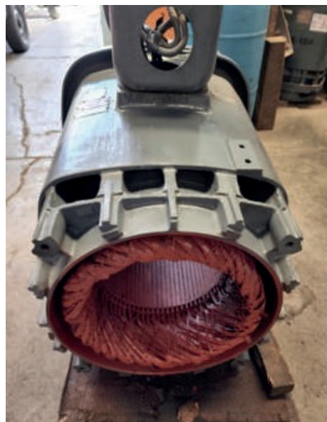
Mantenimiento de motor de 200 hp de pozo El Paseo II
